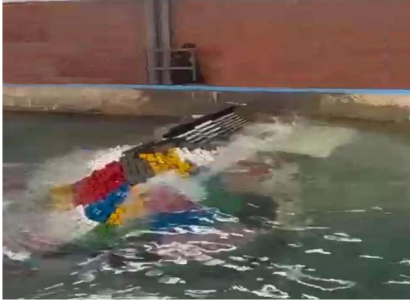
ODTÜ Labaravatuvarında Yapılan Basamaklı Dalgakıran Keson Deneyi /
